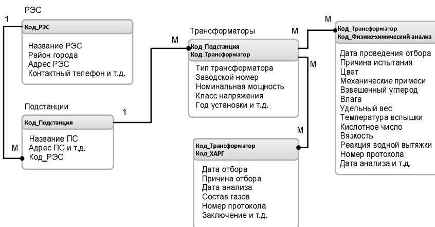
Рис. 3 – Реляционная структура БД ИАС «Сирена»
